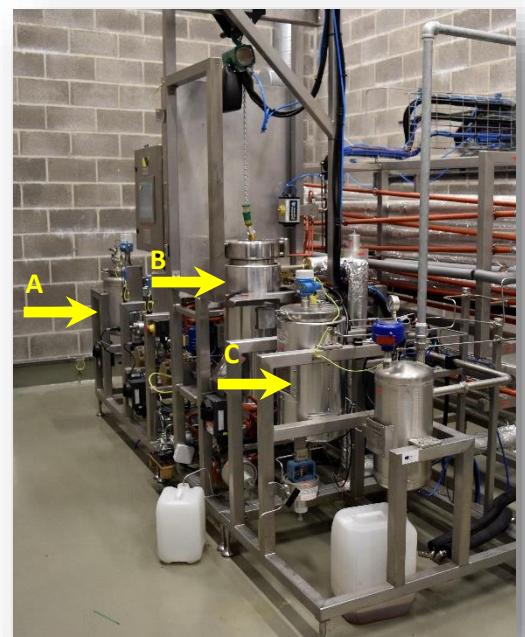
Figure 2: Pilote d'extraction à l'eau subcritique. A: réservoir d'eau; B: Reactor; C: collecteur d'extrait
